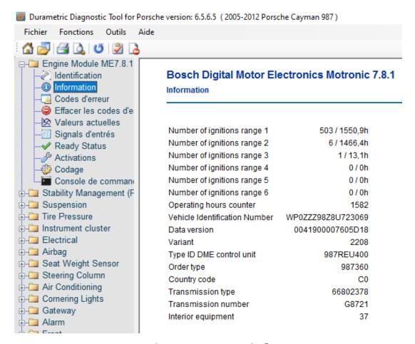
Vitesse moyenne : 76 597 km / 1 582 h = 48,42 km/h → Trajets essentiellement mixtes, la moyenne classique se situant à environ 50 km/h.
